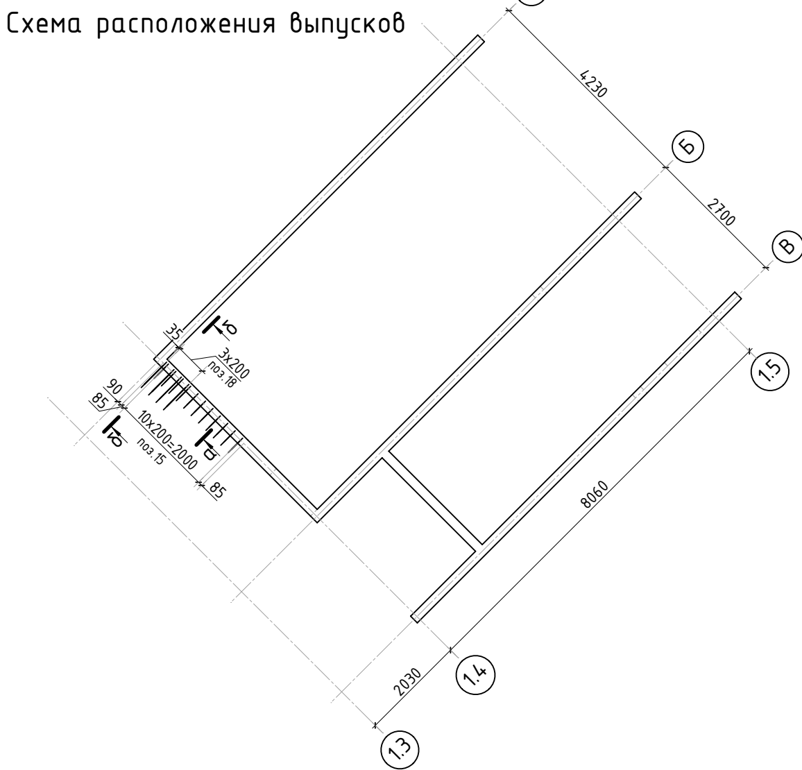
Схема вертикального и доп. армирования
